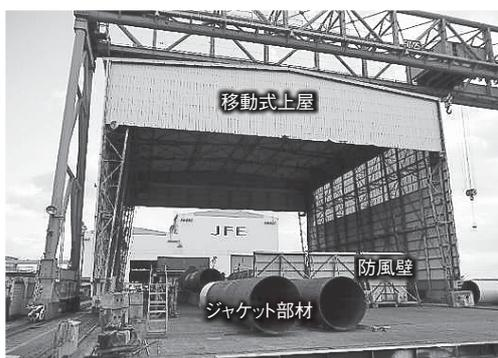
写真-3 ジャケット工場製作<平面組立>
