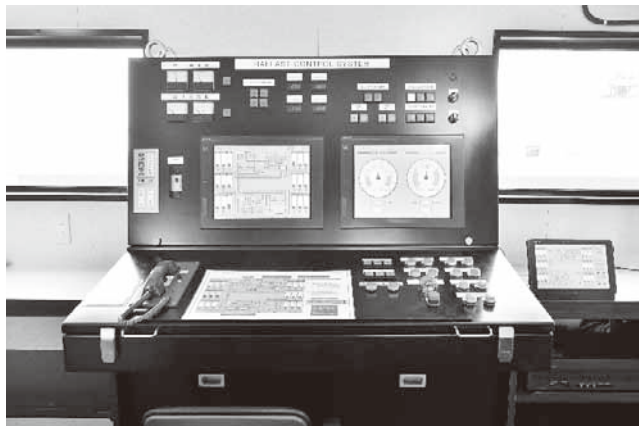
写真3 タッチパネル式バラスト遠隔制御装置とタブレット
