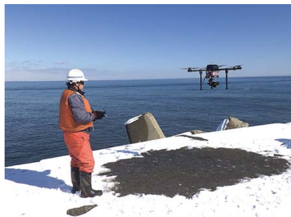
UAVによる測量状況
