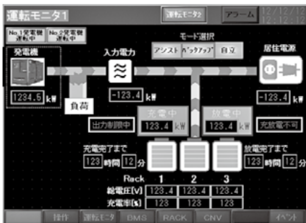
図-5 蓄電システムモニター画面
