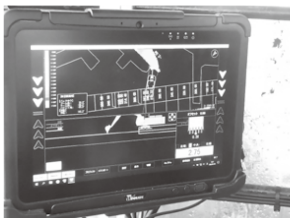
【施工位置、水深の確認状況】
